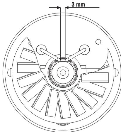
**SCHEMA DI POSIZIONAMENTO TUBO FUMI - PLAN DE MONTAGE DE LA CHEMINEE
